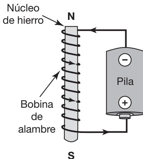
Durante la investigación, el estudiante observó que un clip se movía hacia el electroimán cuando el electroimán se colocaba cerca del clip. El estudiante decidió cambiar el número de bobinas de alambre alrededor del núcleo de hierro del electroimán y anotó los resultados en la siguiente tabla.
